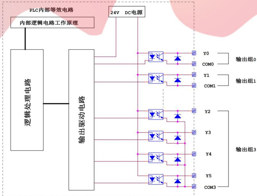
图 3-6 晶体管输出等效电路
