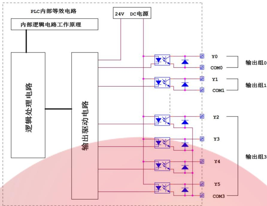
图 3-7 负载保护电路
