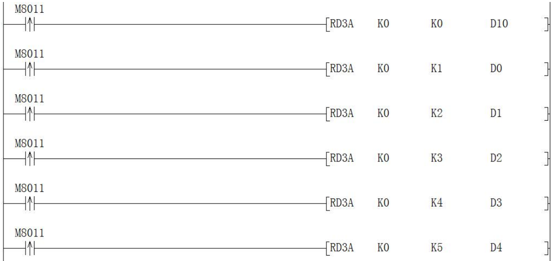
图 3-7 模拟量输入程序例子
